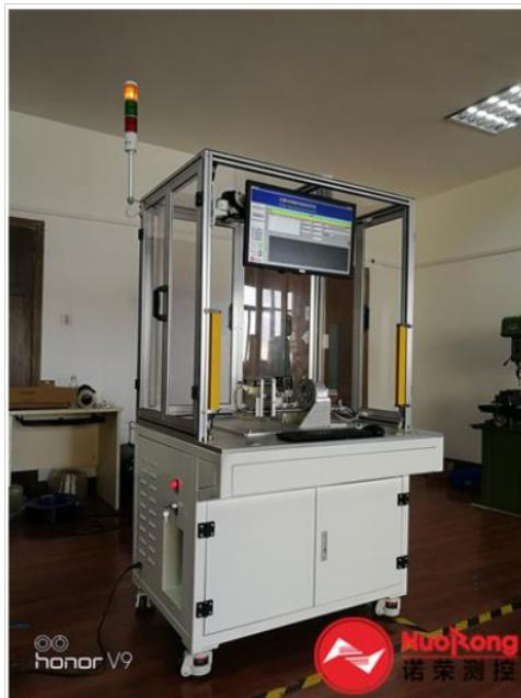
综合性能测试仪适用汽车性能测试、工程机械性能测试、液压系统测试。是压力、流量、温
